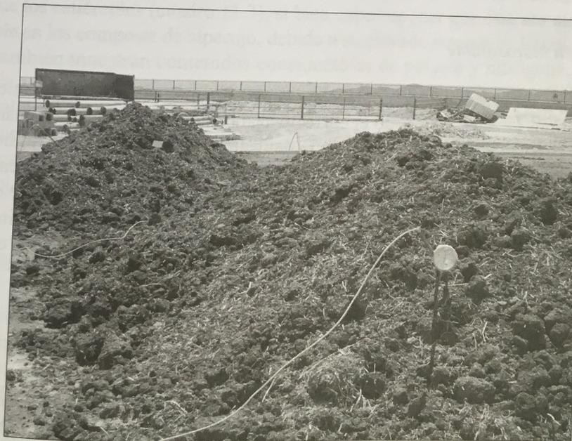
FIGURA 11.3. Vista general de unas pilas de compostaje con las sondas de temperatura.
