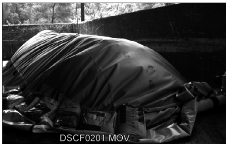
Figura 1. Pila ventilada cubierta con geotextil, sistema de ventilación impulsada y control de temperatura.
