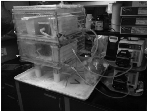
Figura 2. Prototipo utilizado en la recuperación de amonio
